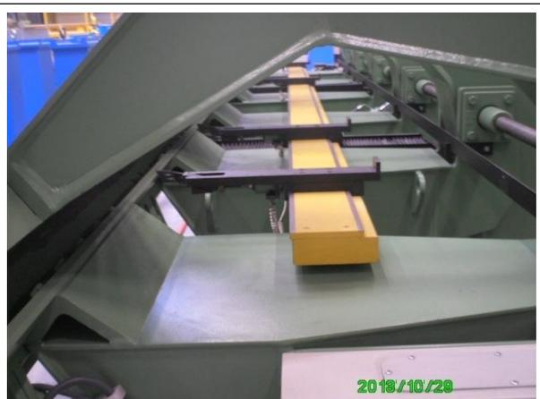
Butée arrière et doigts de butées
